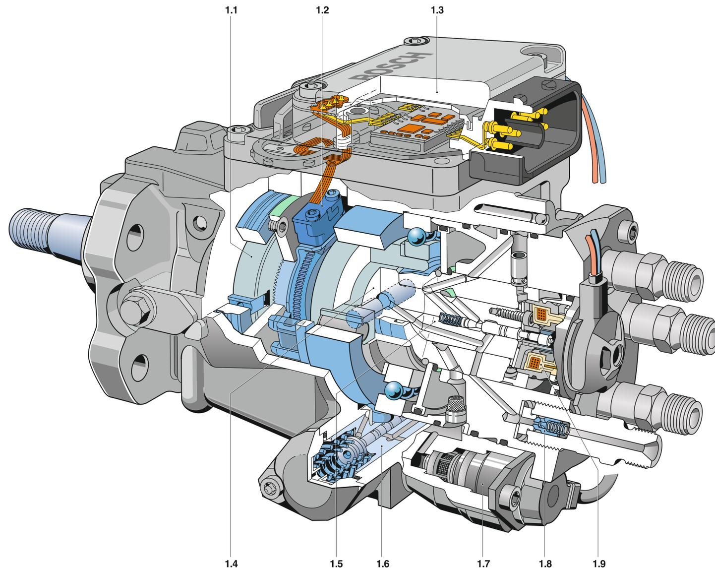
Система электронного управления дизельным двигателем (EDC) для радиально-поршневых насосов распределительного типа.
